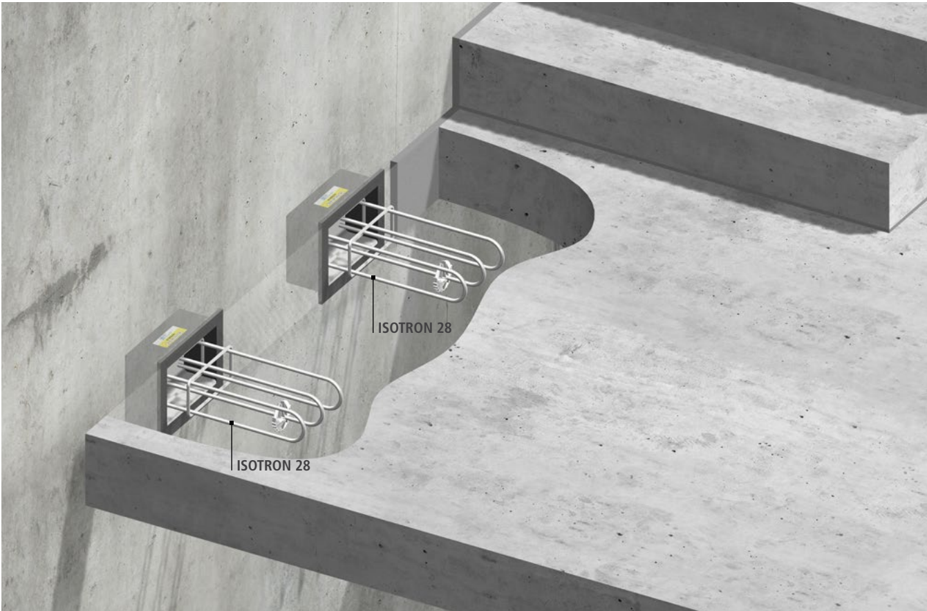
Représentation schématique : la disposition, le nombre et le type des appuis de palier doivent être déterminés en fonction du projet
