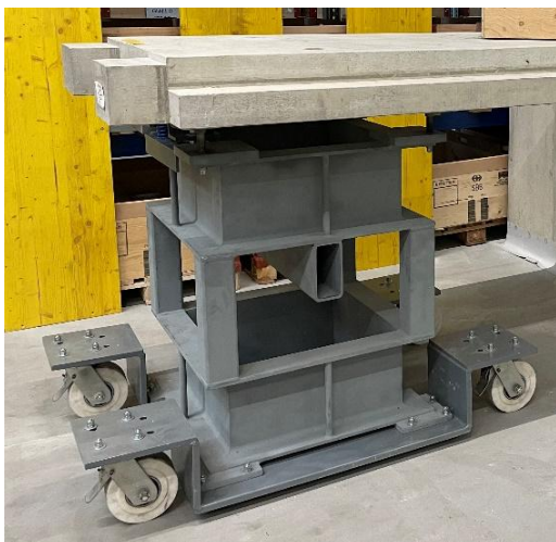
Abbildung 5: Montagewagen als Hilfswand
