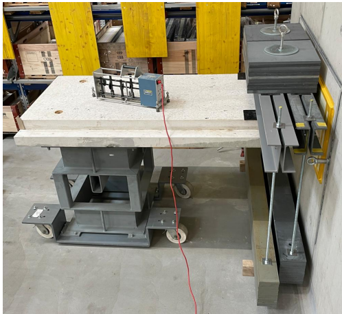
Abbildung 3: Aufbau Podest mit Podestlagern und Zusatzlasten
