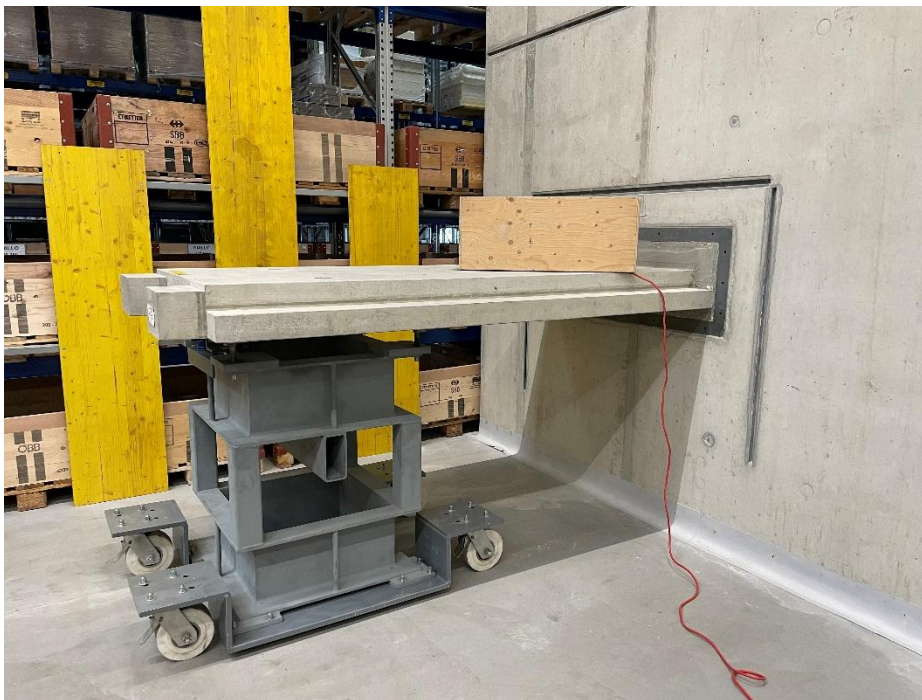
Abbildung 7: Trittschallmessung des starr angebundenen Podestes ( L_{n0,Podest} )
